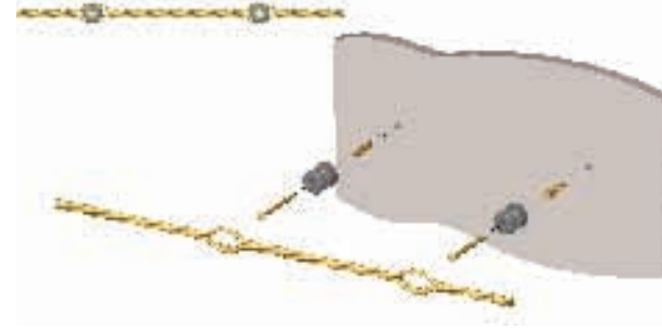
Instalación de cable trenzado con aisladores Installation of intertwined cable with insulators Installation de câble torsadé avec isolateurs
